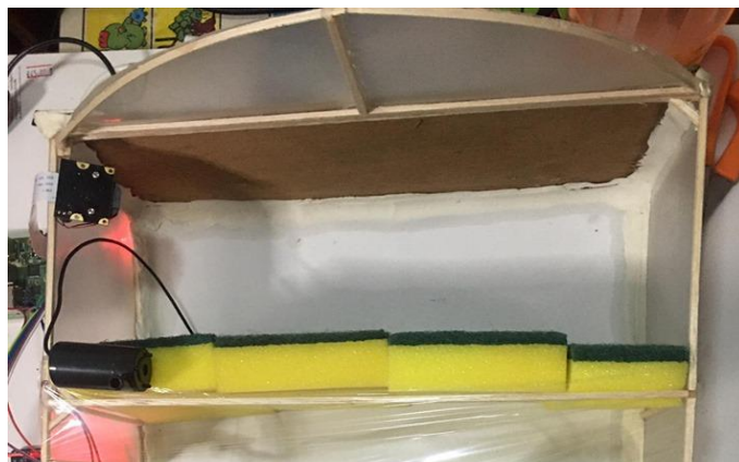
ภาพที่ ก.4 การติดตั้งปั้มน้ำและแผงระบายความร้อน
